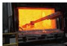
福島事業所鍛造工場の様子。回収したアルミを溶解し、高品質なビレットに再生します。
