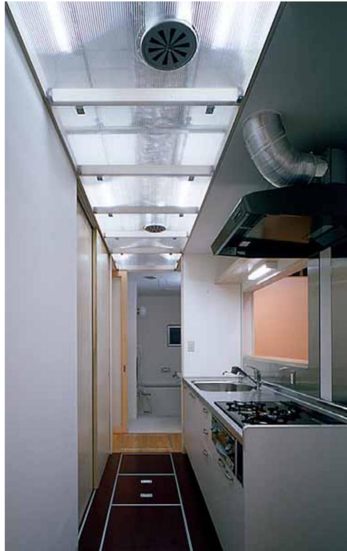
中央コア部分 天井裏および床下ピットに設備配管が集約されている。
