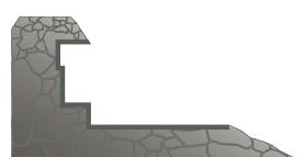
急斜面地に計画するため、建築物の基礎部分を、床版として兼用する方法を探用した。
