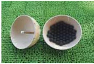
**玉込め（たまごめ）作業**：花火を組み立てる作業です。玉皮の内側に沿って星をきっちり隙間なく並べます。細かい工程を経て、最後は合わせ目を紙テープで貼ります。
