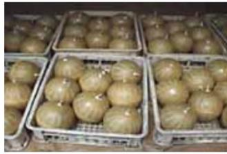
**玉皮**：花火の容器になる玉皮は、ダンボール紙のような材質。導火線は玉が上空に昇りきったところで、割薬に火が届くよう計算されています。
