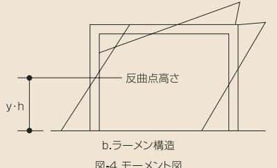
図-4bでyを反曲点高さ比と言います。yに階高h(柱の長さとします)を乗じたものをyhを反曲点高さと言います。反曲点高さは、その名前の通り、柱のモーメントが反転する高さで、モーメントがゼロになる高さです。
