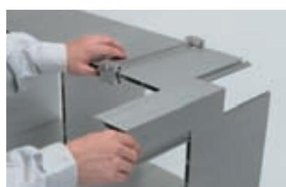
7.不安定な状態でネジを締めるのではなく、組み立てツールで固定し、コーナーの部材も入れて安定させた状態でネジを締めるようにしてください。
