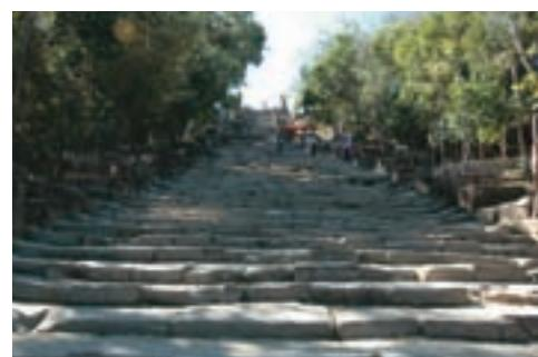
上部に行くに従って幅を狭く計画して距離感覚を操作している
