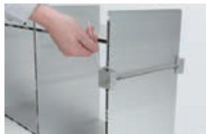
4.小口がずれそうの場合には組み立てツールで小口をそろえ、それからネジ止めするようにします。
