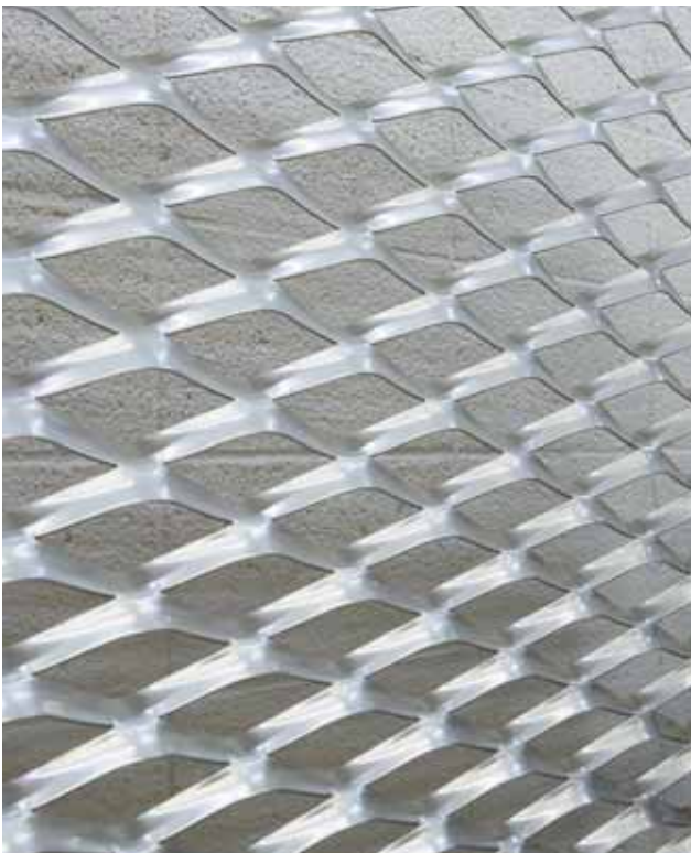
ニュー・ミュージアムの外壁に張られるアルミエクスバンドメタルのモックアップ。
