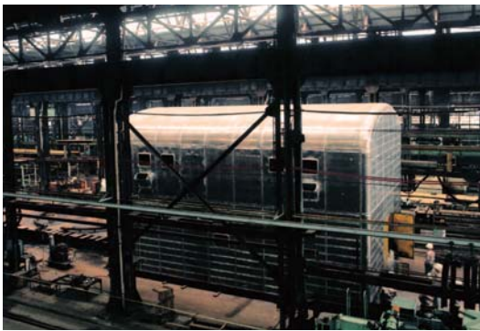
車両製造工場内で製作された庁舎。
