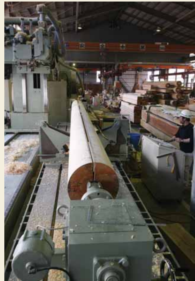
かつては手作業で四角形、八角形、16角形、32角形としてから丸太にしていたが、今は機械なので八角形の材をすぐに丸柱にできる。
