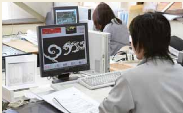
CAD・CAMを用いて虹梁の彫刻を行う。
