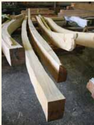
破風裏甲。材のもつ曲がりを生かして使用する。
