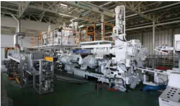
タイ工場に導入された押出機
