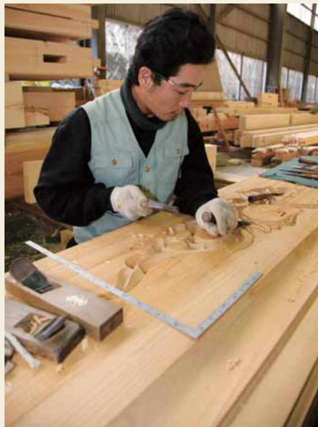
CAD・CAMを用いても最後の仕上げは手仕事。10種類以上のノミを使い分け見事な彫刻ができる。
