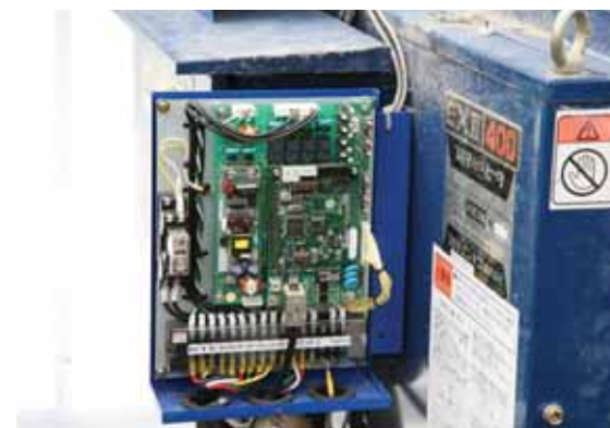
最新の環境制御装置「UECS」は装置にコンピュータを搭載している。
