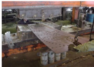
PC制御で1つ1つ穴が開けられスチールパネルはプレス機を用い手作業で曲げられる。※
