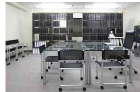
グリッドシェルフの転倒防止対策にはアルミパイプ構造材GFを使用している。
