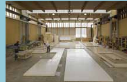
壁、床、天井を構成する木質パネルの製造現場。
