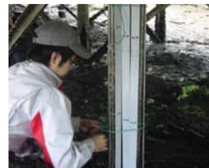
調査日より5年間行う暴露試験では、6種の表面処理仕様とボルト・ナットを組み合わせたサンプルを設置。
