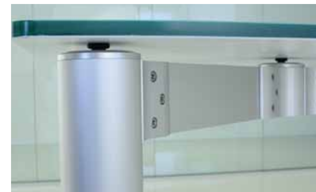
W1000×D2200mm、100kg超のガラス天板を支えるアルミフレーム。φ100mmの脚柱、梁背100mmの横架材、新型のコネクタがガラス天板を支えます。
