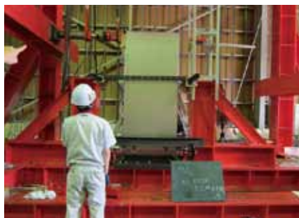
せん断破壊試験。断熱性能や耐火性能のみならず、強度についても実証済みです。
