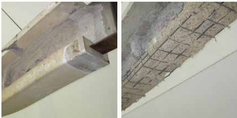
高強度コンクリートを用いた鋼との合成梁の耐火試験結果。左が爆裂対策あり、右が爆裂対策なし。
