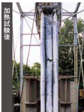
柱（H-300×300）の載荷加熱試験 （試験機関：日本建築総合試験所）
