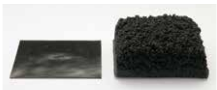
2mm厚シートが20mmに膨張（ブチルゴム系10倍膨張品）
