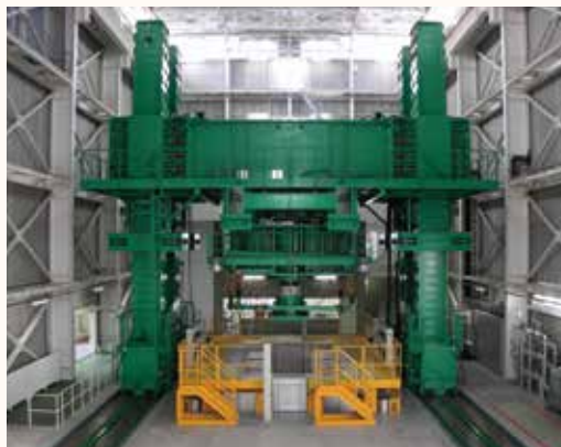
2009年に完成した新耐火実験棟と耐火試験炉。30MN（メガニュートン）まで積載可能で、世界でも最大級の施設となる。
