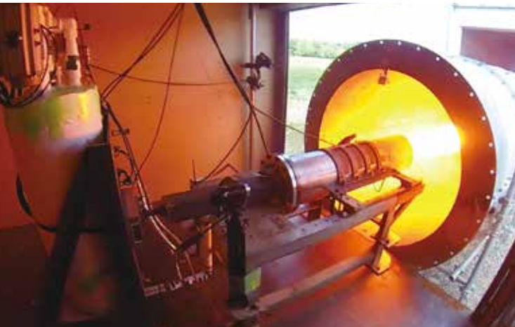
1tf(重量トン)級地上燃焼試験。成層圏気球と組合せて超音速飛行環境実験の実現を目指す、推力1.5tf(重量トン)級エンジンを開発するための基盤データを取得しました。
