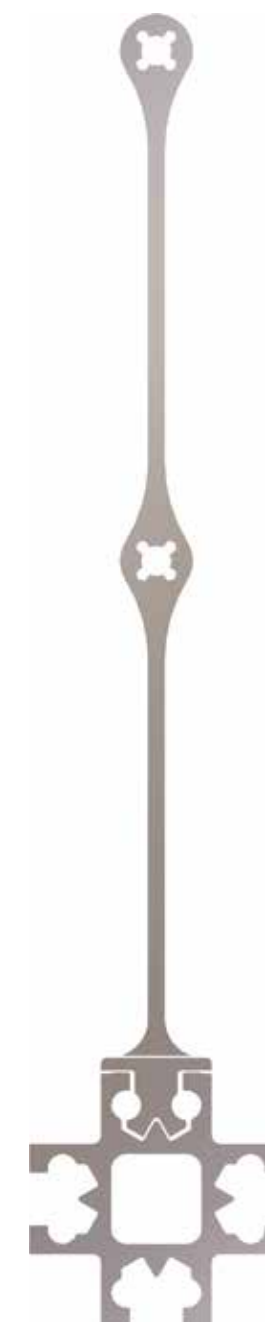
■HALFタイプ アルミ押出側板断面(原寸)
