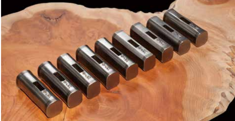
玄能の基本的な形9種（長谷川幸三郎作）。左から、丸、小判口丸、四角親方、石堂、千代鶴、八角、互平八角、一文字、丸定型一文字。
