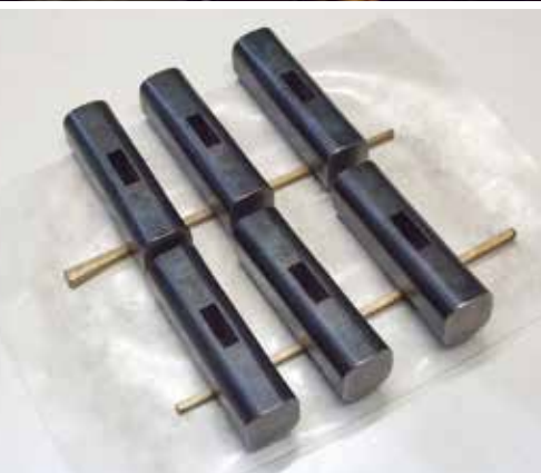
（上）焼き入れ。まず打撃面を流水で冷やしてから、下に貯めた水で全体を冷やす。その後、お湯に入れて冷やすスピードを緩める。（右下）焼入れ前に打撃面を砥石で研ぐことにより焼入れ時の冷却速度が速まり、理想的な焼き入れができるという。（左下）仕上がった玄能。
