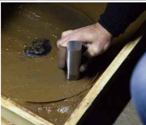
（上）焼き入れ。まず打撃面を流水で冷やしてから、下に貯めた水で全体を冷やす。その後、お湯に入れて冷やすスピードを緩める。（右下）焼入れ前に打撃面を砥石で研ぐことにより焼入れ時の冷却速度が速まり、理想的な焼き入れができるという。（左下）仕上がった玄能。
