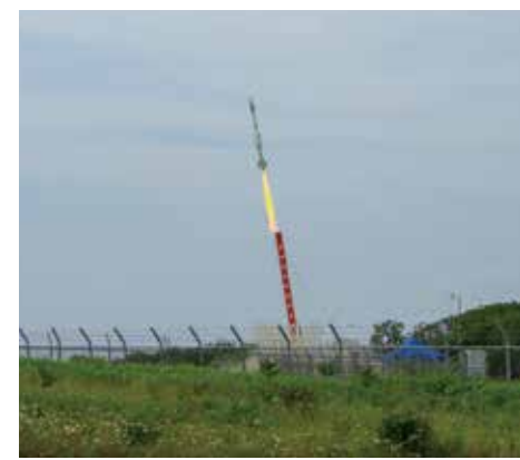
2012年に打ち上げられた推力500kg級ロケット。超音速環境での飛行に成功。搭載された機器により超音速環境での飛行特性を得ることができた。特記なき写真は、永田晴紀氏提供。
