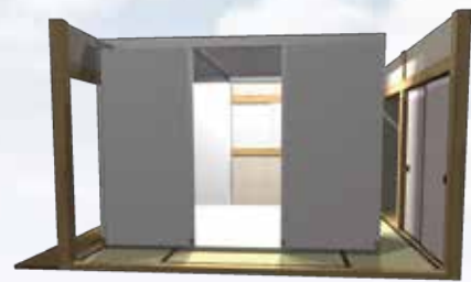
既存木造家屋内につくられた耐震シェルター。
