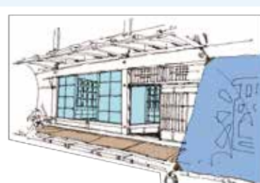
古民家内に耐震シェルターを設置し、店舗として使用する例。
