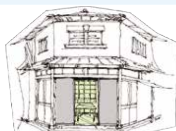
古い商店に耐震シェルターを利用したショールームを設ける例。
